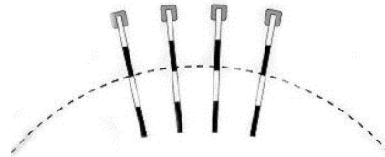
Zweckmäßiger fächerartiger Aufbau mit 4 Stangen
